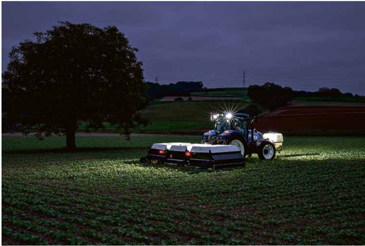
L'une des machines d'Ecorobotix, équipée de caméras repérant chaque mauvaise herbe, avant de pulvériser des pesticides avec précision. (SVEN DE ALMEIDA/ECOROBOTIX)
